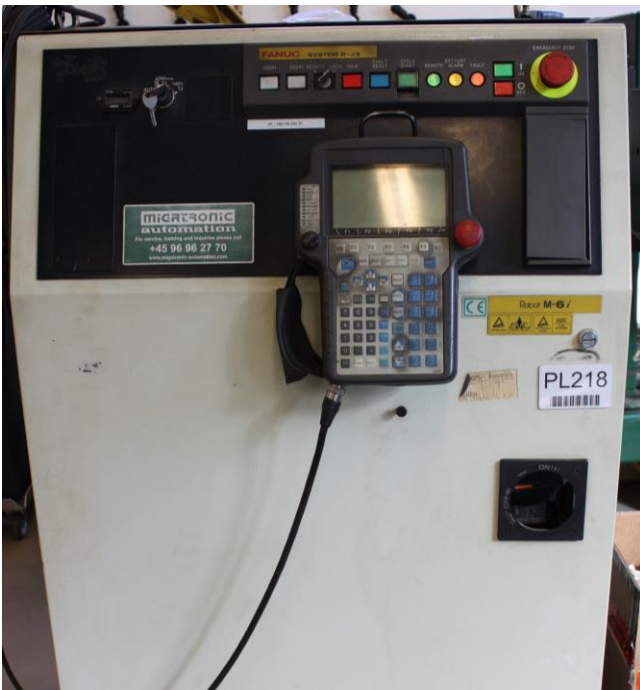
An den relevanten Schnittstellen der Steuerung des Fanuc Roboters wurden die notwendigen Verknüpfungen erstellt, damit zwischen der alten Steuerung R-J3 und der modernen DIX PI Stromquelle Signale ausgetauscht werden können.
