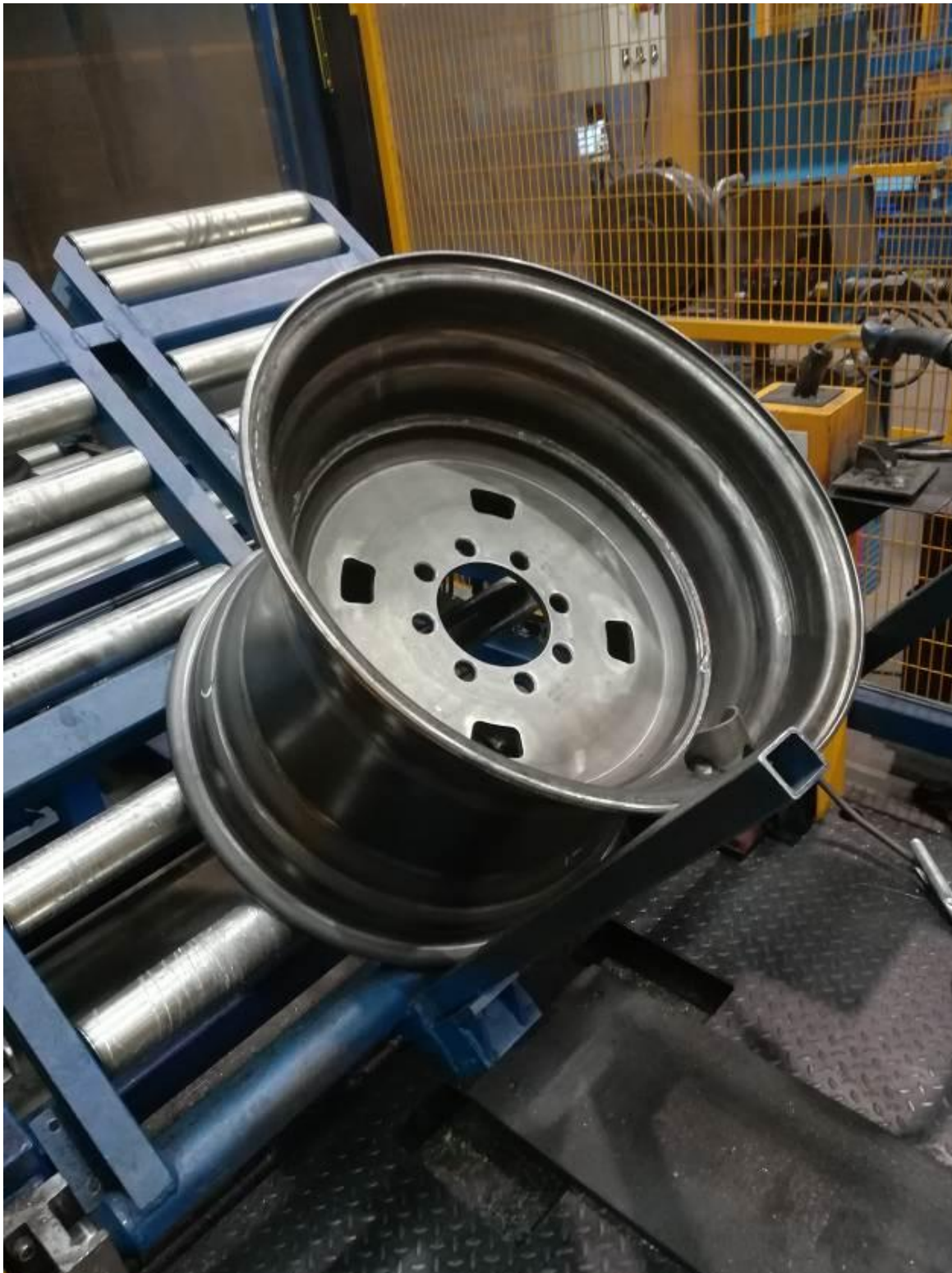
Stahlfelge für schwere Landmaschinen. Um das Rad zu produzieren, müssen die Felgen mit dem Felgenflansch verschweißt werden.
