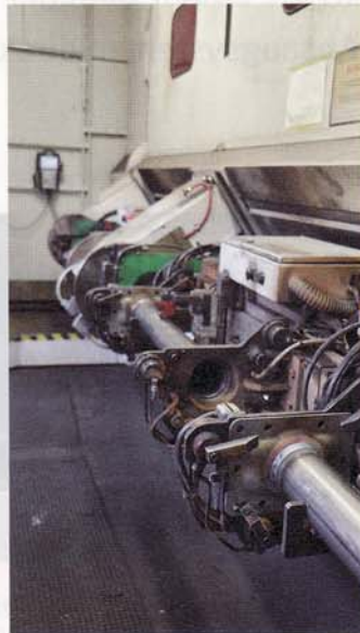
Außenansicht einer Roboterschweißzelle: Hier werden die frisch gelegten Nähte von LKW-Komponenten (Rohrquerträger) geprüft, anschließend die nächsten Teile eingelegt und zum Schweißen in die Zelle eingeschwenkt
