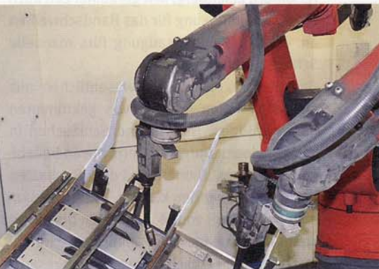
Mit 6-achsigen Robotern und dem auf einem Schwenktisch montierten Werkstück werden bei HAP selbst schwer zugängliche Bereiche geschweißt. Für gleichbleibend hochwertige Schweißergebnisse sorgen nicht zuletzt die Dinse-Schweißpistolen
