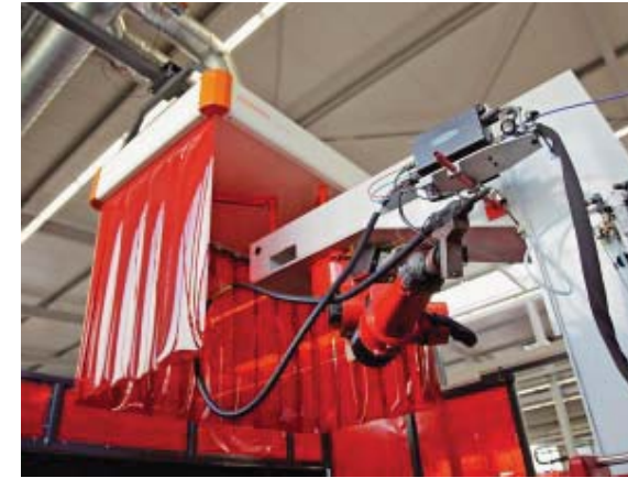
Auch ein Schweißroboter arbeitet mit. Sobald er aktiv wird, schaltet sich automatisch die Absaughaube Variohood ein. Bild: Sputnik
