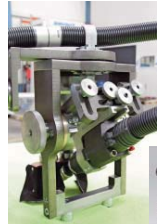
Positioniereinheit des Schweißtraktors mit der Roboter-Schweißpistole Dinse Dix Metz 570
