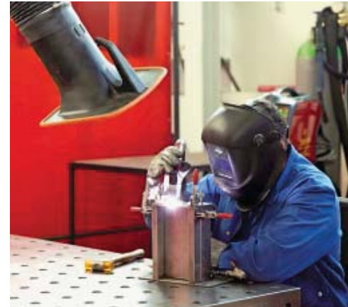
Schweißerarbeiten unter dem Absaugarm: Kemper stattete die neue Produktionshalle der ASW GmbH mit Absaug- und Filtertechnik aus
