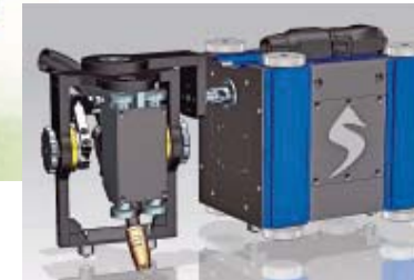
So ist der komplette Schweißtraktor mit Positionier- und Antriebseinheit aufgebaut
